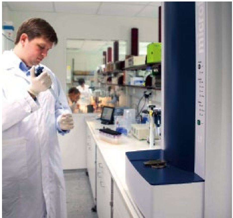
Abb. 2: Die MALDI-TOF-MS-Analyse ist genauso zuverlässig wie die DNA-Sequenzierung, jedoch günstiger. Erster Schritt des Verfahrens ist die Gewinnung eines Keimisolats aus Fruchtsaftproben. Im MALDI-TOF-MS-Gerät erfolgt die massenspektrometrische Analyse des Isolats. Deren Ergebnis wird mit den in der MALDI-Biotyper-Datenbank hinterlegten Referenzspektren abgeglichen und die Keime dadurch identifiziert. © Bruker Daltonik
