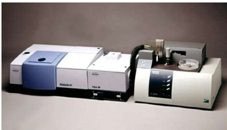
Abb. 1: TG-FTIR Kopplungsapparatur Netzsch TG209F1 mit Bruker Tensor27
