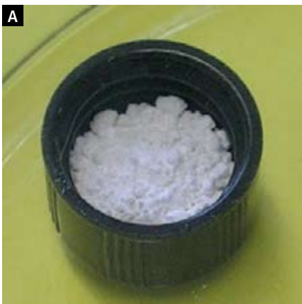
Abb. 4: (a) nach 1 Stunde (b) nach 10 Stunden (c) nach 17 Stunden Fotografische Dokumentation der Volumenzunahme während der Hydratation von \text{La}_2\text{O}_3 zu \text{La}(\text{OH})_3 .
