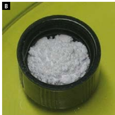
Abb. 4: (a) nach 1 Stunde (b) nach 10 Stunden (c) nach 17 Stunden Fotografische Dokumentation der Volumenzunahme während der Hydratation von \text{La}_2\text{O}_3 zu \text{La}(\text{OH})_3 .
