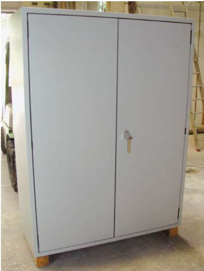
Abb. 2: Außenansicht des zur Brandprüfung vorbereiteten zweiflügeligen Sicherheitschanks von asecos.
