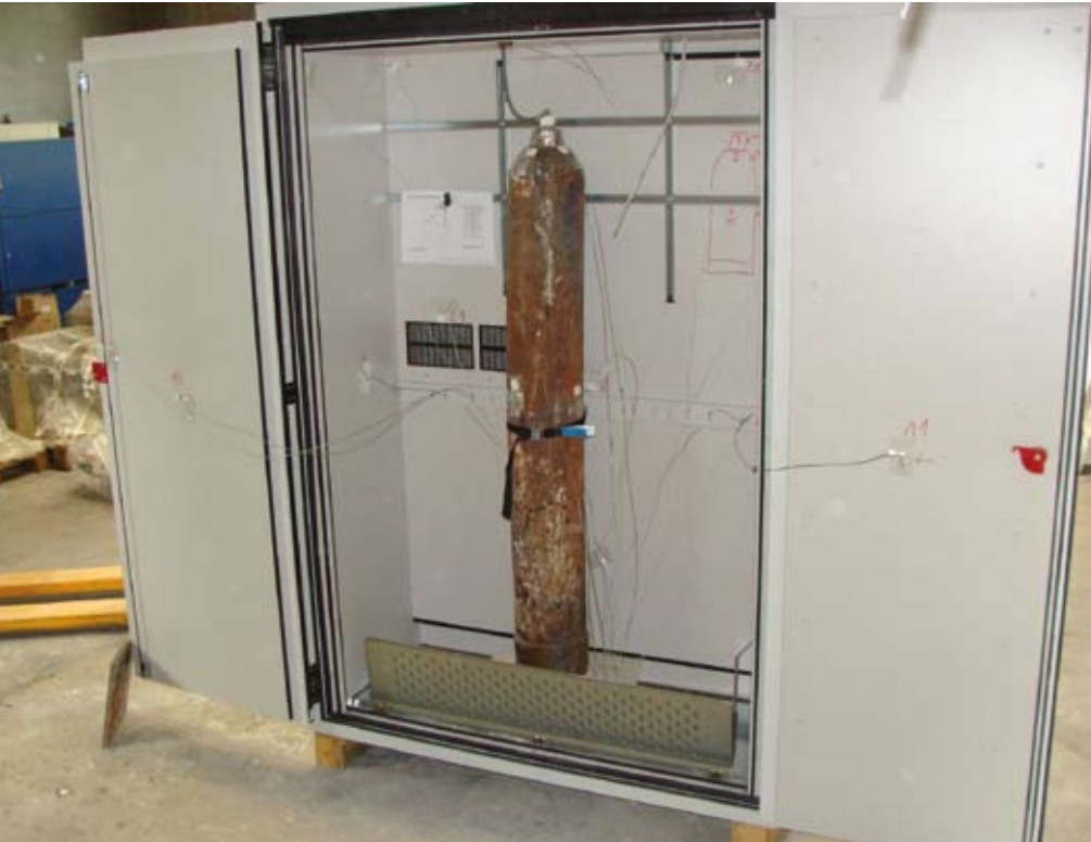
Abb. 1: Innenansicht des zur Brandprüfung vorbereiteten Sicherheitsschranks zur Lagerung von Druckgasflaschen.
